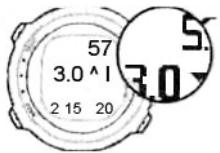
*Когда на экране появляются надписи CEILING (потолок) и STOP (остановка), следует произвести обязательную остановку безопасности в течение одной минуты в диапазоне глубин от 6 до 3 метров.*
