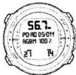
*Активация режима погружения NITROX DIVE. На основании установленного значения 02% (21 %) и P02 (1,4 bar), максимальная операционная глубина составляет 56,7 м.*
