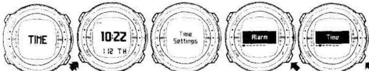
*Используйте кнопки UP и DOWN, чтобы переключаться между настройками будильника, времени, поясного времени, даты, единиц измерения, включением подсветки и звуковых сигналов*
