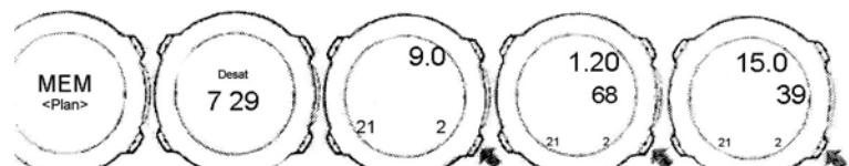
При входе в режим планирования MEMplan сначала дисплей на некоторое время показывает оставшееся время десатурации, а затем переходит в режим Санирования. Для
