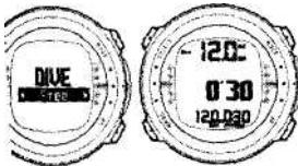
При активации режима FREE компьютер можно использовать для фридайвинга. В этом режиме в центре дисплея отображается общее время погружения в минутах и секундах.
