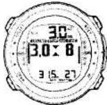
*Две стрелки указывают друг на друга - символ песочных часов. Вы находитесь на оптимальной глубине в зоне потолка 3 м.*
