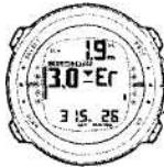
*Погружение с декомпрессионными выдержками. Нахождение над потолком. На дисплее отображается стрелка, указывающая вниз, предупреждение об ошибке Eg, подается звуковой сигнал. Вы должны немедленно (в течение 3 минут) опуститься до потолка или ниже.*
