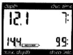
Позже Aladin Pro переключается в режим готовности к работе. При этом дисплей остается включенным, и при соответствующих условиях высвечивается информация высотного режима.
