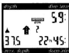
В режиме погружений активны все функции компьютера: отслеживаются глубина и время погружения, заносится в память максимальная глубина, рассчитываются показатели насыщения тканей с допуском на температуру, определяется время безостановочного погружения или прогноз декомпрессии, контролируется и высвечивается рекомендуемая скорость всплытия, отслеживается правильность проведения декомпрессии.
