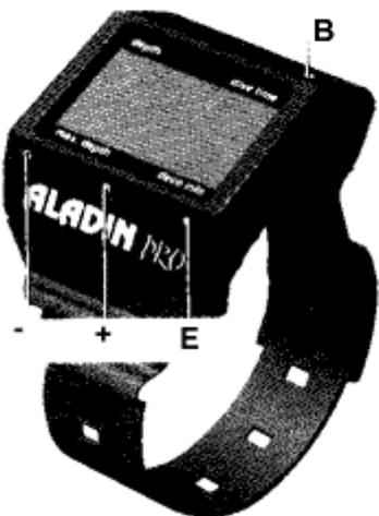
: Контакт ввода, служащий для включения компьютера, запуска журнала, режима планирования и переключения между планированием безостановочных и декомпрессионных погружений. Помимо этого он используется для подтверждения ввода, т.е. сравним с клавишей ENTER или RETURN обычного компьютера.
