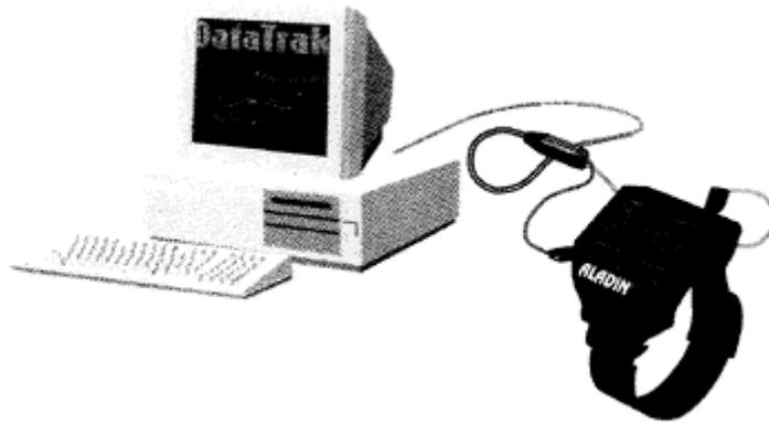
Время и дата погружения вводятся автоматически с часов PC системы во время передачи данных через интерфейс.
