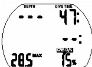
По достижении поверхности Аладин (< 0.8 м ) автоматически переключается в режим ожидания на 5 минут. Этот промежуток времени необходим для распознавания завершения погружения. Он позволяет дайверу всплыть на поверхность, сориентироваться и продолжить погружение.
