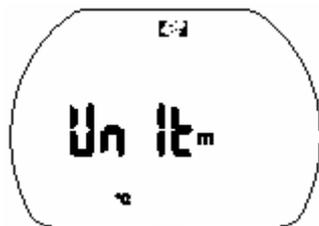
1. Подтвердить вход в режим нажатием . Высвечиваются установленные единицы (m / ft / °C / °F).
