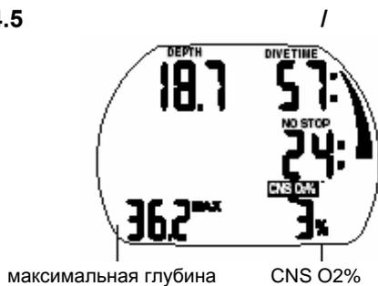
Показатель максимальной глубины высвечивается, если он превышает значение текущей глубины более, чем на 1 метр. Если показатель максимальной глубины не высвечивается, Аладин показывает температуру.
