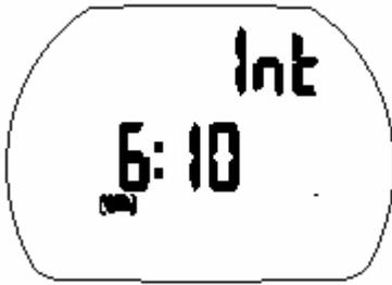
Из главного дисплея часов Вы можете перейти к индикации поверхностного интервала нажатием кнопки
