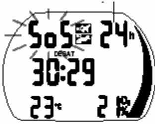
Если дайвер остается более трех минут на глубине, меньшей 0,8 метра, не осуществляя при этом предписываемую компьютером процедуру декомпрессии, после погружения компьютер переключается в аварийный режим, и вместо показателя глубины появляется символ <SOS>. Компьютер блокируется на следующие 24 часа. Все вычисления, касающиеся декомпрессии, продолжают осуществляться, в том числе и определение количества микропузырьков в тканях. Выполнение следующего погружения
