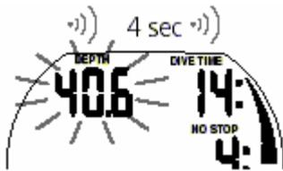
С помощью программы SmartTrak может быть установлено предельное значение максимальной глубины погружения (обычно 40 м). При превышении этого предела выдается сигнал предупреждения и показатель глубины начинает мигать. Действие: Всплывайте на несколько метров, чтобы предупреждающий сигнал погас.
