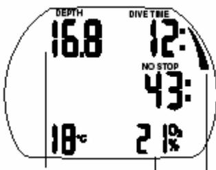
Показатель текущей глубины определяется с шагом в 10 см. При включении и на глубине, меньшей 0.8 метра, появляется пустой дисплей <-->
