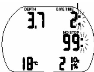
Общее время, проведенное на глубине ниже 0.8 метра, высвечивается в минутах и называется временем погружения. Пока погружение продолжается, двоеточие справа от цифр мигает с односекундными интервалами. Максимальное высвечиваемое на дисплее время погружения равно 199 минутам.
