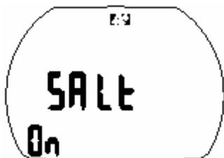
1. Подтвердить вход в режим нажатием . Статус Вкл./Выкл. Salt On – означает соленую воду, Salt Off – пресную.
