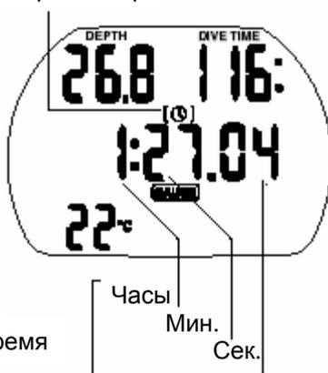
При погружении в режиме измерителя, ТЕС автоматически отслеживает время погружения и одновременно активирует секундомер-хронометр. Хронометр запускается максимум на 24 часа.
