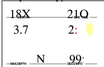
Общее время, проведенное на глубине ниже 0.8 метра, высвечивается в минутах и называется временем погружения. Пока погружение продолжается, двоеточие справа от цифр мигает с односекундными интервалами. Максимальное высвечиваемое на дисплее время погружения равно 199 минутам.
