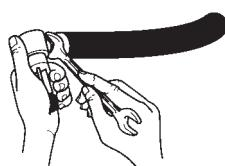
Закрепите соединение с помощью гаечного ключа.
