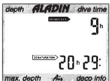
Aladin® Air находится в поверхностном режиме. Появляется стрелка DESATURATION, рядом с которой показано время рассыщения в часах и минутах. Время рассыщения продолжает высвечиваться до начала следующего погружения, или до тех пор, пока его значение не станет равным 0. В целях экономии энергии батареи дисплей выключается через 3 минуты после последней операции с прибором (поверхностный спящий режим). При этом расчеты, касающиеся рассыщения тканей, продолжаются.
