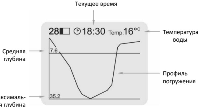
Цвет линий профиля погружения также показывает возможные превышения оптимальной и максимальной скорости (согласно настройкам VSI). Поэтому, вам будет легко определить возможные нарушения в профиле погружения (обратный профиль, пилообразный профиль, и т.д.), которые могут потребовать удлинение декомпрессионных остановок или увеличение поверхностного интервала перед следующим погружением.
