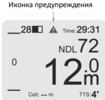
Включение режима предупреждения вызывает необходимость выполнить требуемую остановку безопасности и/или автоматическую регулировку степени консерватизма. Время остановки безопасности варьируется от 3 до 8 минут и зависит от величины превышения скорости всплытия. После такого погружения вы должны значительно увеличить поверхностный интервал. Мы строго рекомендуем воздержаться от погружений в течение как минимум 24ч.
