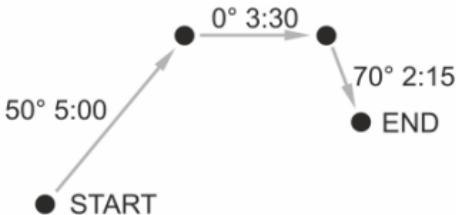
Для того чтобы создать список курсов, подключите устройство к компьютеру, с помощью USB кабеля, и загрузите файл "HEADING.TXT" в каталог "HEADINGS". Это текстовый файл, который содержит значение азимута (в градусах) и время, необходимое для преодоления этой дистанции (в секундах), разделенные точкой с запятой. Каждый отрезок пути должен быть помещен в отдельную строку. Например:
