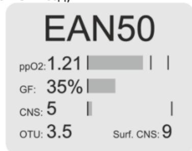
В верхней части экрана отображается активный газ. Ниже – следующая информация:
