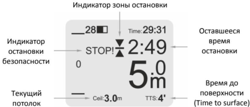
Устройство отображает два типа остановок:
