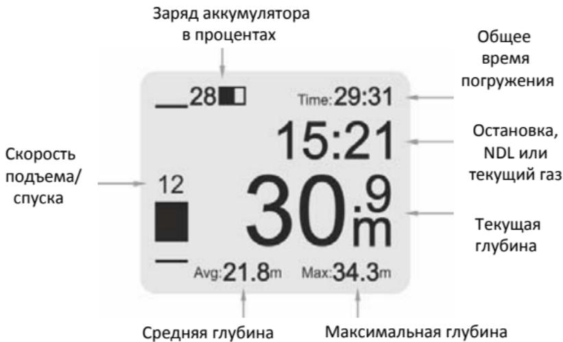
В режиме "Gauge (BT)", устройство показывает среднюю глубину погружения вместо потолка.
