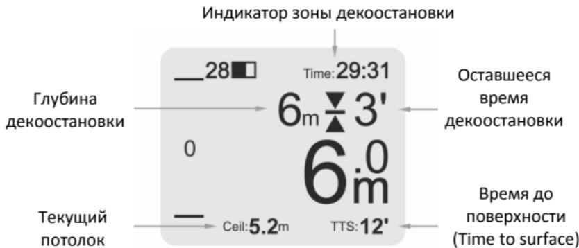
Декоостановки выводятся на экран кратными 3м (или 10 футов в случае имперских единиц измерения).
