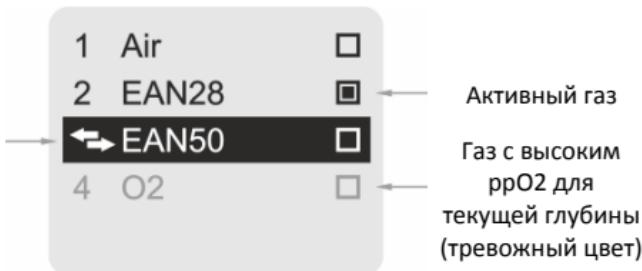
Активный газ отмечен значком выбора . Газ, рекомендуемый в качестве оптимального, отмечен значком переключения газа , и курсор будет автоматически установлен на него сразу же после входа в меню переключения газа. Газы, которые на конкретной глубине имеют слишком высокое значение парциального давления, чтобы дышать ими безопасно, отмечены в списке тревожным цветом. После подтверждения переключения газа, BLACK EANx автоматически вернется на главный экран.
